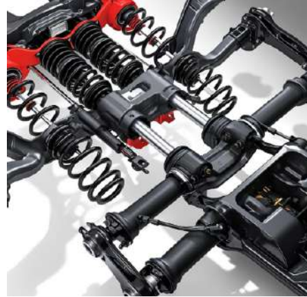
Figura 5.3.3 Resorte en la industria automotriz (suspensiones)
