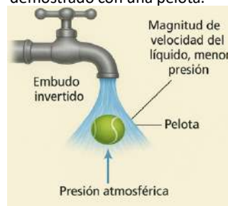
Figura 7.4. Ecuación de Bernoulli demostrado con una pelota.
