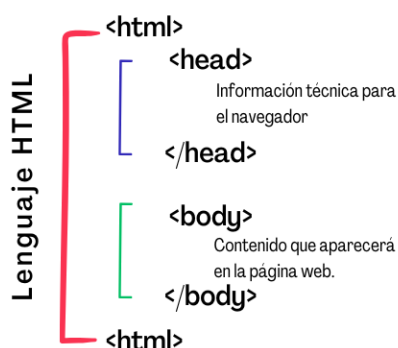
Figura 2 Estructura básica de una página en HTML
