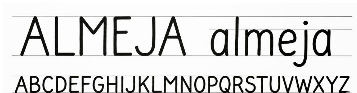
Imagen 1.24. Posición correcta de las letras en el rotulado
