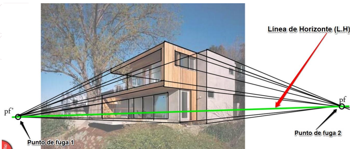
Ilustración 55. Cuando los objetos son oblicuos respecto al observador, experimentamos que el largo y el ancho del objeto fuga a puntos distintos del horizonte. Este fenómeno es el que replica el dibujo en perspectiva a dos puntos de fuga.
