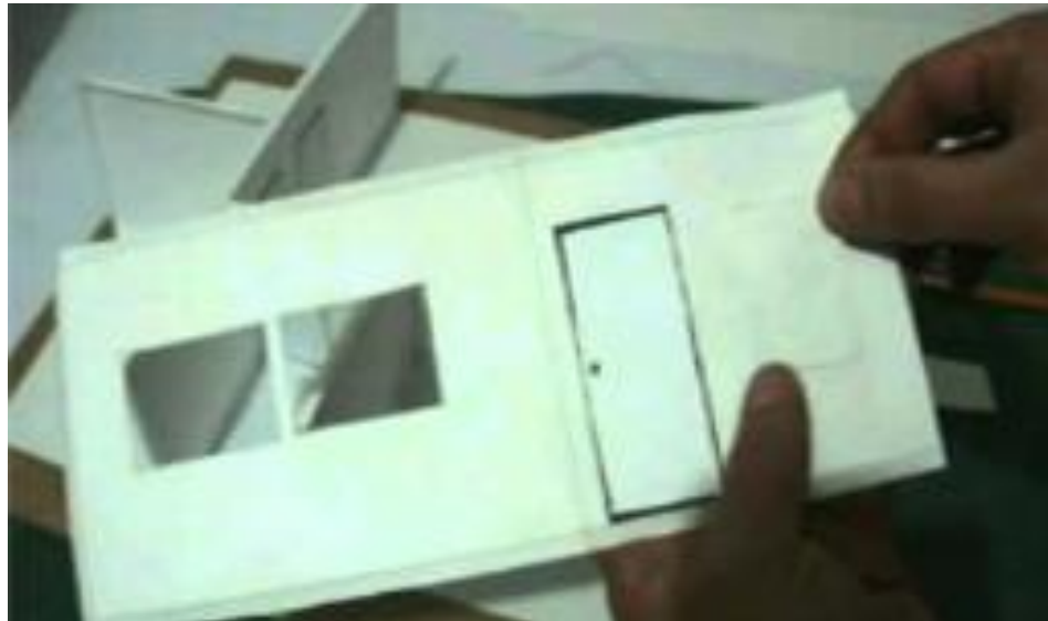
Fig. 2.14. Se puede iniciar por el despiece de los muros señalando las ventanas y puertas.
