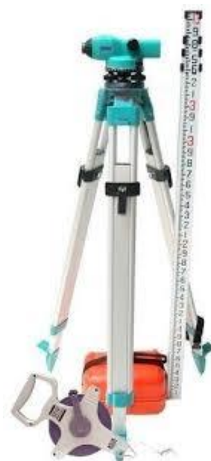
Imagen 13. Nivel fijo, con estadal y cinta métrica
