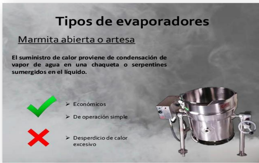
FIGURA 2.9 EVAPORADOR MARMITA ABIERTA O ARTESA
