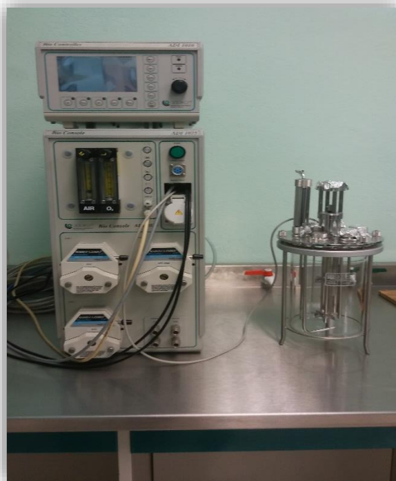
FOTOGRAFÍA 2.34 BIORREACTOR CON TANQUE AGITADO USADO PARA FERMENTACIONES A ESCALA LABORATORIO, SÁNCHEZ VÁZQUEZ, 2018
