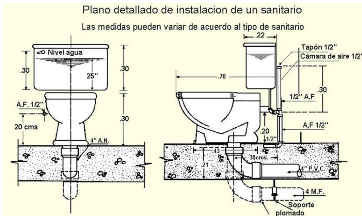
Imagen 2.19. Conexión del sanitario a la red doméstica
