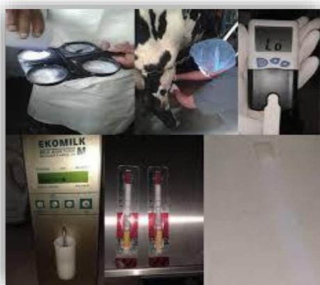
Fig. 2.38 Equipo Ekomilk para determinar adulteraciones en leches.
