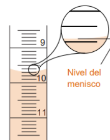
Fig. 1.2 Bureta con menisco a 9.68 mL. Estimar la lectura en una escala hasta la décima de una división. Esta bureta tiene divisiones de 0.01 mL, por tanto, estimamos la lectura hasta 0.01 mL.
