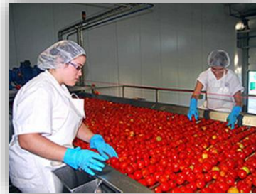
Fig. 2.36 Procesos de selección de tomates por métodos físicos.
