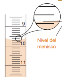
Fig. 1.2 Bureta con menisco a 9.68 mL. Estimar la lectura en una escala hasta la décima de una división. Esta bureta tiene divisiones de 0.01 mL, por tanto, estimamos la lectura hasta 0.01 mL.
