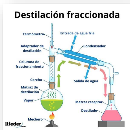
Fig. 2.12 Equipo para destilación fraccionaria. Fuente: https://www.lifeder.com/destilacion-fraccionada/
