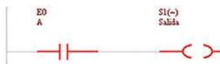
Función lógica NO inversora con la entrada A en “1”
