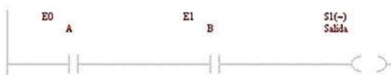
Función lógica AND (Y) con las entradas A y B en “0”
