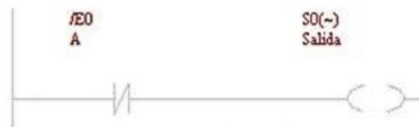
Función lógica inversora NOT con la entrada A en “1”
