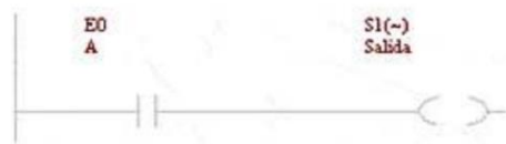
Función lógico NO inversora con la entrada A en “0”
