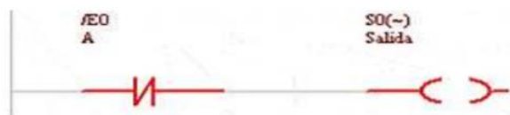
Función lógica inversora NOT con la entrada A en “0”
