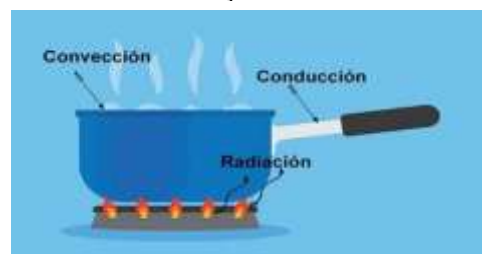
Figura 1.2 Mecanismos de transferencia de calor.
