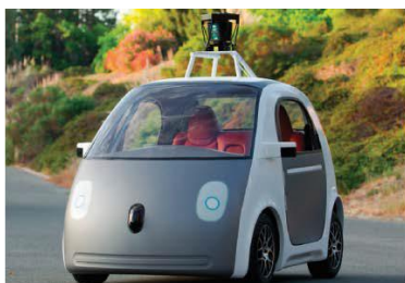
Fig. 3.5 Google car diseñado para ser autónomo (sin volante ni pedales)
